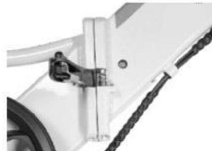
Étape 2 : Poussez fermement le loquet vers le bas jusqu'à ce qu'il se verrouille en position. Tirez sur le loquet pour confirmer qu'il est verrouillé et que le vélo ne peut pas s'ouvrir.
