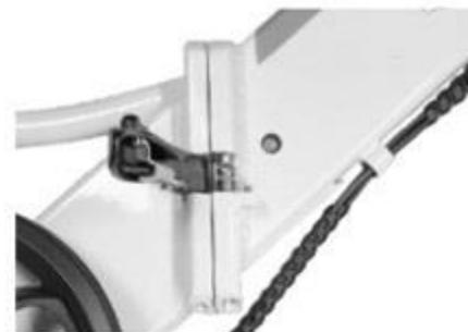
Étape 2 : Tirez sur le loquet tout en maintenant l'interrupteur en position « ouverte ».
